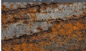
زنگ‌زدگی در تماس با رطوبت و اکسیژن
